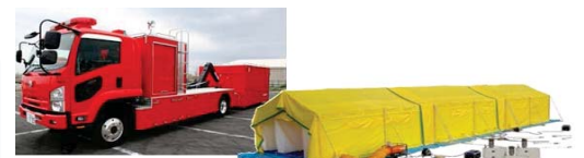
大型除染システム搭載車
